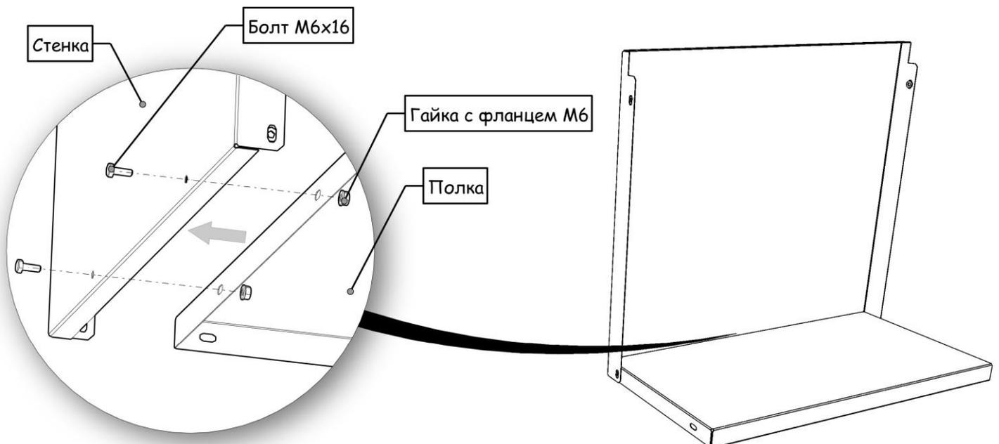
3.3.2. Установка опор и тумб. В зависимости от комплектации закрепите полку-стенку между опорами (а), опорой и тумбой (б) или между тумбами (в).
