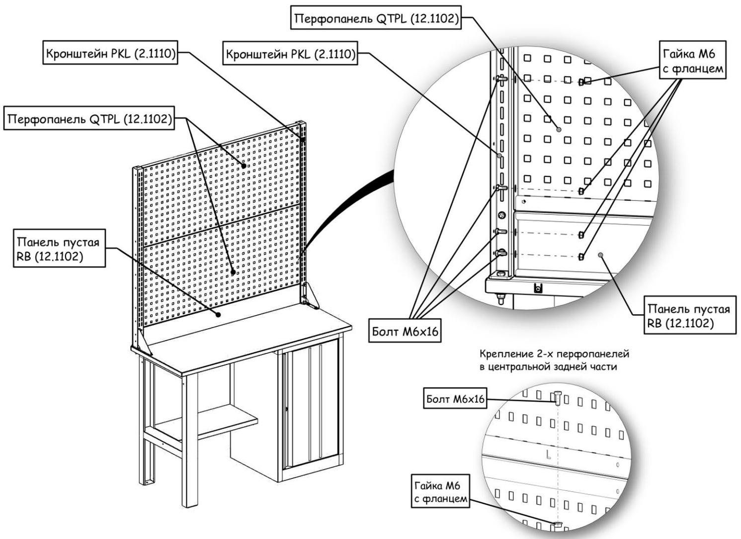
3.3.6. Затяжка резьбовых соединений верхней части. Проверить правильность установки комплектующих элементов верстака или стола, кронштейны должны быть расположены вертикально. Затянуть крепёжные элементы соединяющие кронштейны, косынки и столешницу. Затянуть крепёжные элементы, соединяющие пустую панель, перфопанели и кронштейны.
